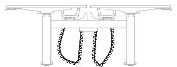
Électrification verticale flexible avec guidage, du chemin de câble inférieur à la table sur poste en vis-à-vis.
